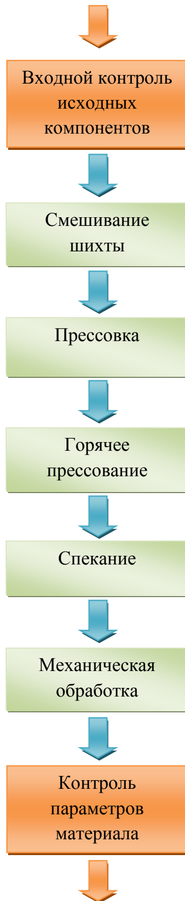
Рисунок 4.1 – Разработанная технологическая схема производства SiC-Al
