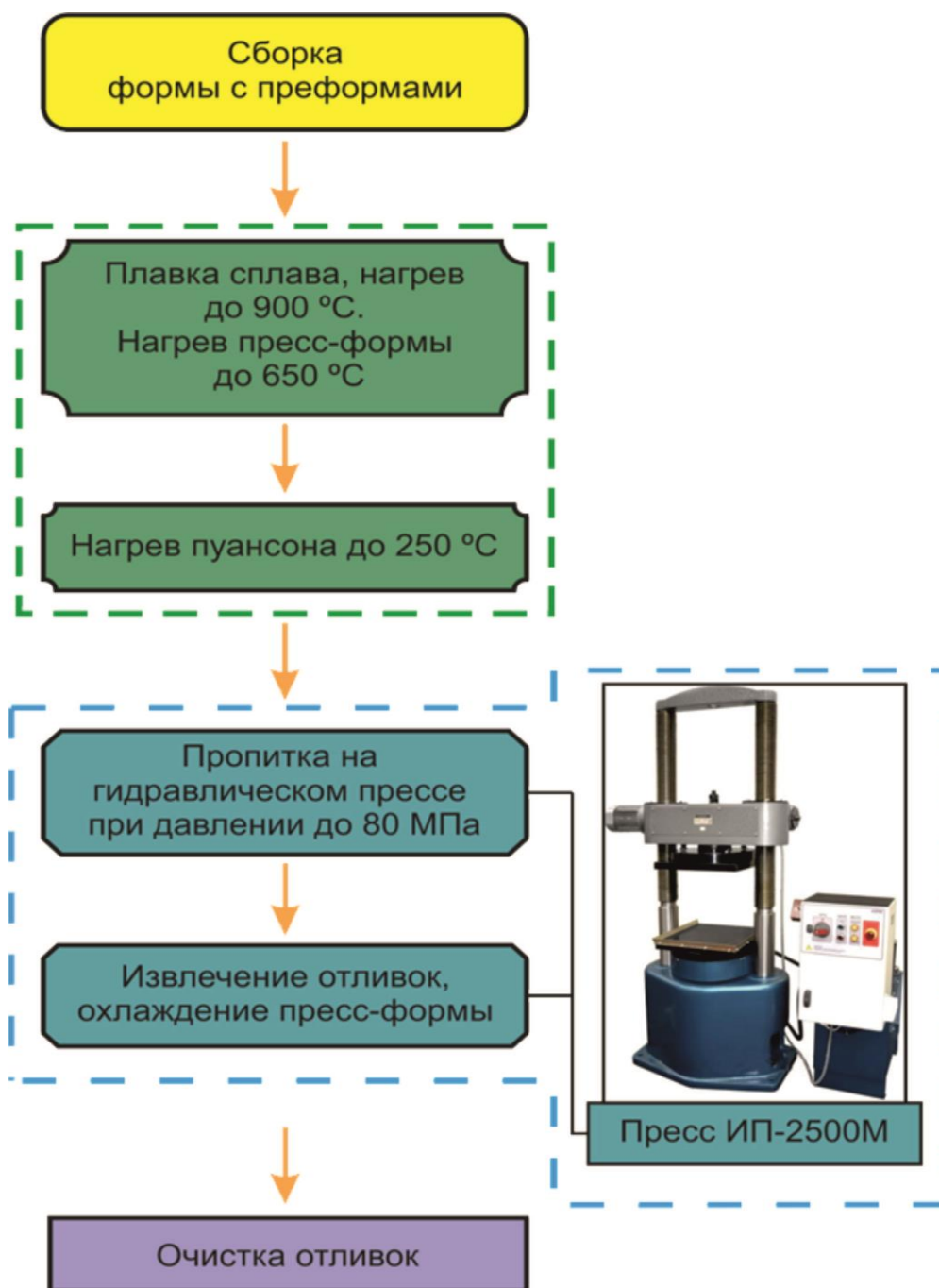
Рисунок 4.11 – Схема процесса пропитки пористых керамических форм под высоким давлением
