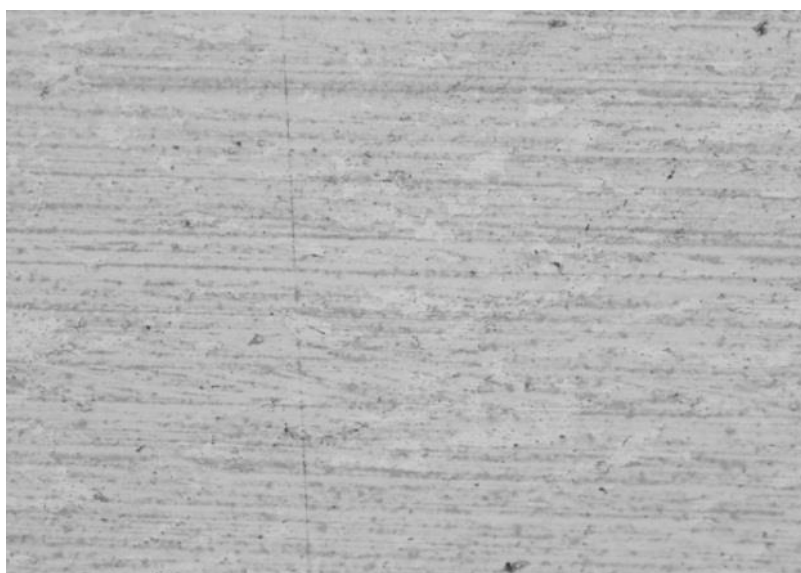
Рисунок 3.5 – Фотография микрошлифа композита МД-50, увеличение 200 крат (улучшенная технология производства)
